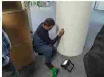
تکمل ۹- انجام عملیات عیابی جوش با دستگاه اولتراسونیک
